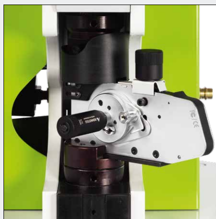
Обжимной блок с универсальным приемником для контактов для промышленных контактов
