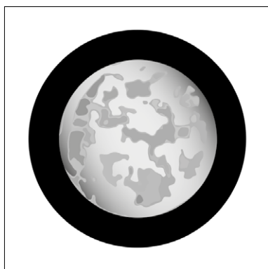
Кабель POF, обрезанный традиционными инструментами – требуется сложная полировка
