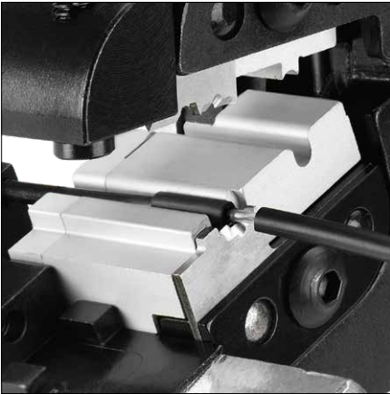
Снятие изоляции с кабеля, а также
