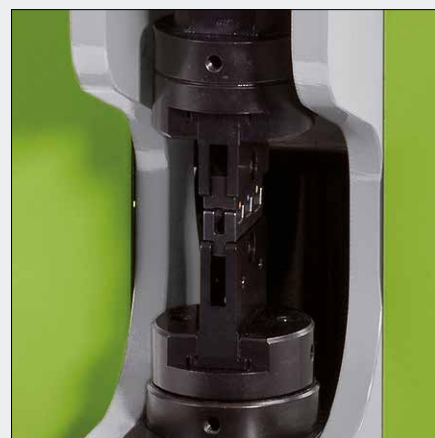
Модель CM 25-6 – обжимной станок с уменьшенным ходом без защитного устройства
