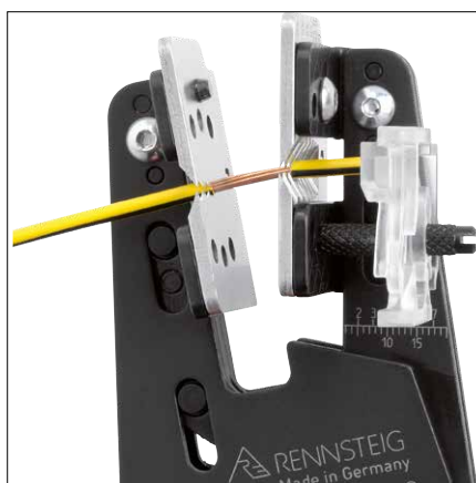
Снятие изоляции с помощью фасонных ножей
