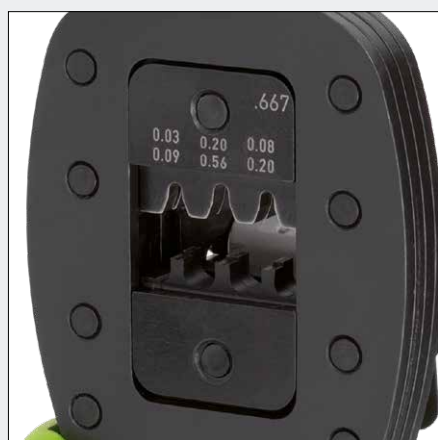
Параллельная подача обжимных губок
