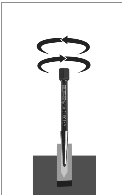
Ослабить затяжку сломанного винта с помощью подходящего инструмента и вывинтить
